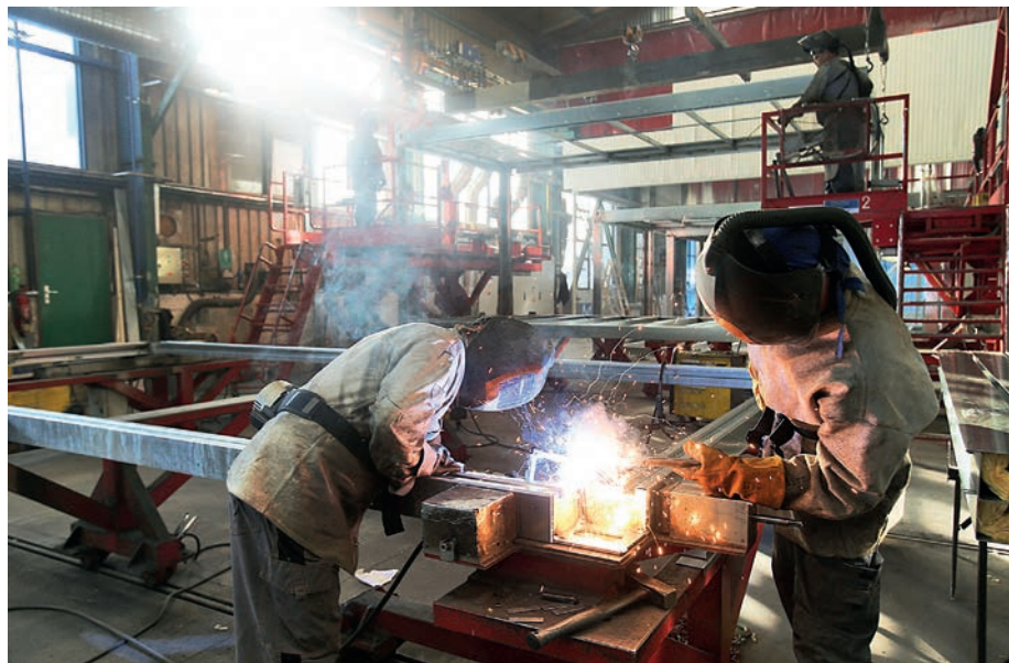
KOSTRA. Základem každého modulu je rám z hliníku, který si vizovická firma sama vyrábí i svajuje. I tímto důrazem na vlastní výrobu od základů se odlišuje od konkurence.
