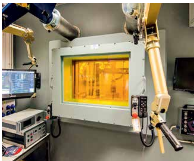
HORKÁ KOMORA. Za téměř metr tlustým sklem budou vědci z CV Řež zkoumat vysoce radioaktivní vzorky.
