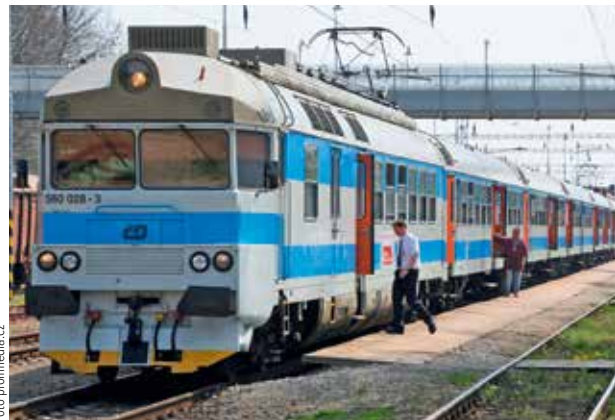
BEZPEČNÉ DVEŘE. Nová čidla by měla zajistit, aby strojvedoucí bez zavření všech dveří v soupravě nevyjel ze stanice.
