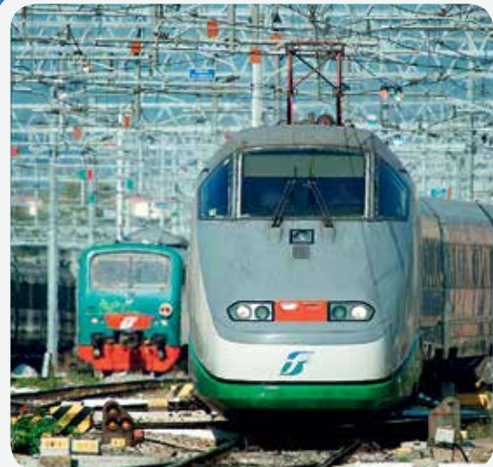
Italské jednotky ETR 500 z půlky 90. let dosahují rychlosti až 300 km/h. Provozovány jsou pod názvem Eurostar.
