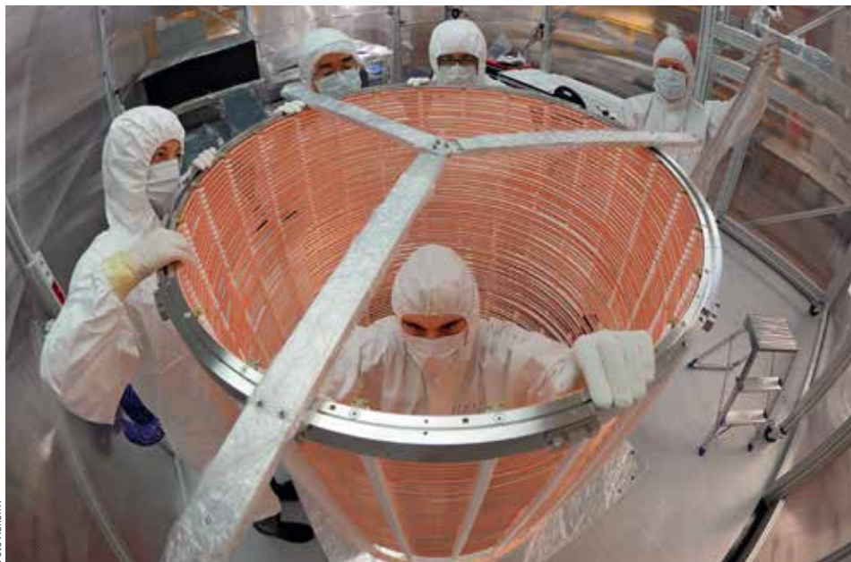
LAPAČ ČÁSTIC. Montáž detektoru temné hmoty vyžaduje laboratorní čistotu a přesnost.
