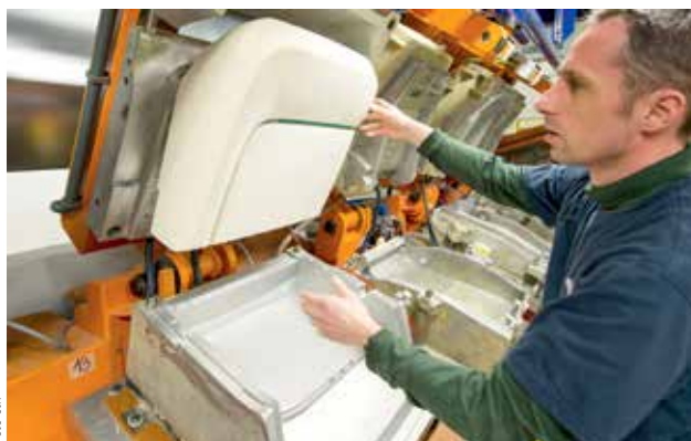
AUTOPRŮMYSL. Odštěpný závod Gumotexu v Jaroměři Tanex Plasty vyrábí velké pěnové díly pro automobilová sedadla.
