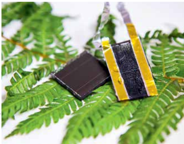
TRICETINÁSÓBEK. Takovou kapacitu poskytují oproti obvyklým konstrukcím nové superkondenzátory.
