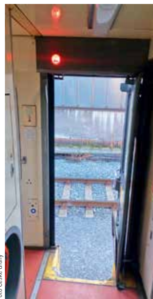
ZABEZPEČENÍ. Červené světlo upozorní zvenku i zevnitř vagonu, že dveře zůstaly otevřené.
