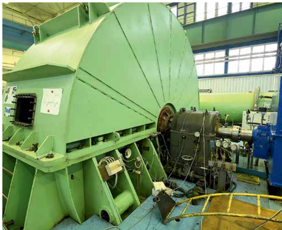
CAMPBELLŮV STROJ. Uvnitř probíhá test odolnosti lopatek proti kmitání.
