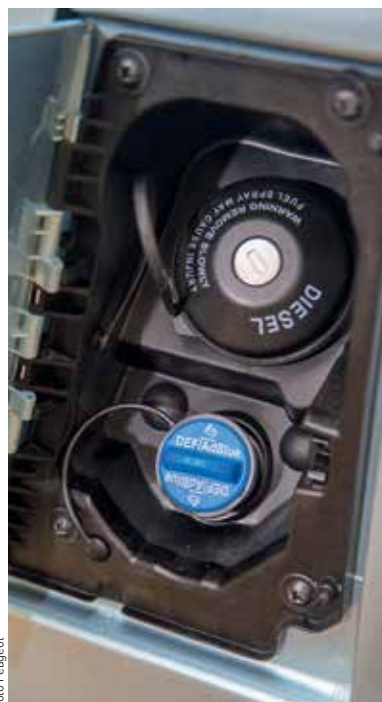
CO NEJEKOLOGIČTĚJI. Modrý uzávěr nádrže činidla AdBlue pro očistu výfukových plynů (Peugeot).
