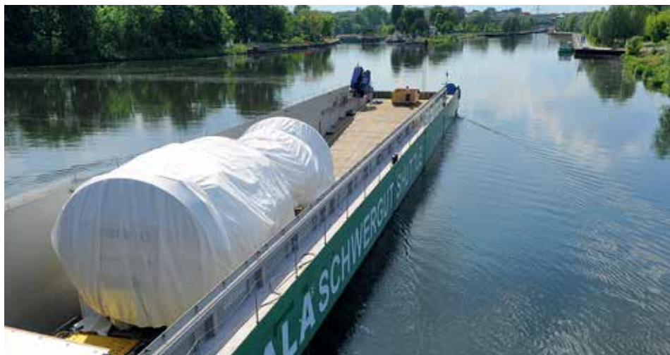
CESTA PO KANÁLE. Před třemi roky vybudoval Siemens speciální rampu, po níž lze vyrobenou turbínu dopravit k nedalekému kanálu a naložit na loď. Dřív ji bylo třeba před přepravou rozmontovat.
