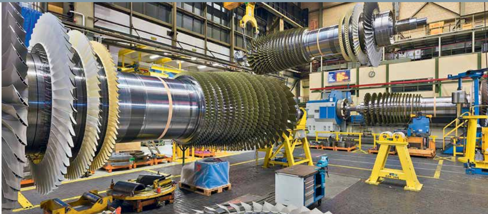
RŮZNOBAREVNÉ LOPATKY. Bílý keramický povlak chrání lopatky před žárem spalovaného plynu. Teplota v komoře je jen o 35 stupňů nižší než bod tání železa.
