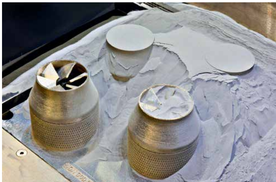
CHVÍLE NAPĚTÍ. Součástky vytištěné laserem je třeba nakonec vyhrabat ze zbytku kovového prášku. Ten se dá znovu použít.
