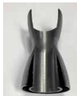
Vnitřní struktura dutého dílce vidlice. Materiál Konstruktivní ocel. Hmotnost 6 kg, rychlost výroby 200 g/hod
