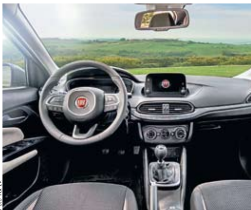
MALÝ ROZDÍL. Přístrojová deska se od sedanu lehce liší. Displej infotainmentu volně stojí, není vestavěný.
