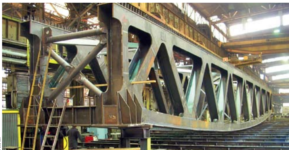
OBŘÍ KONSTRUKCE. Strojírny Vítkovice Power Engineering vyrábějí i mosty. Konstrukce na snímku je součástí železničního mostu na trati Stříbro–Planá u Mariánských Lázní.
