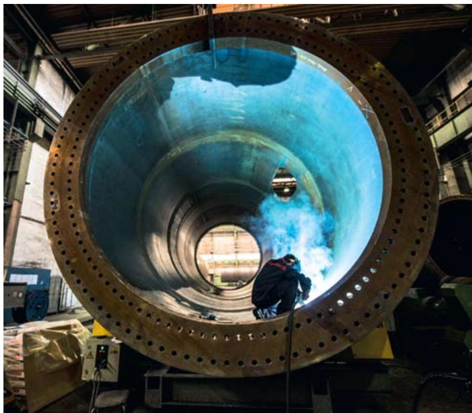
STOŽÁRY PRO VESTAS. Pro dánského výrobce větrných elektráren umějí v chrudimském závodě SIAG vyrobit až sto tubusů za rok. Hotový kolos, který může vážit až 300 tun, vyjede z výrobních linek po 15 až 20 dnech.
